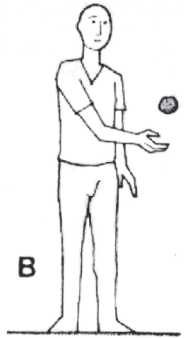
(ခ) ၎င်းမြေသားလုံးအား လေထဲသို့ ၁ ပေခွဲ ခန့် မြှောက်ပြီး ပြန်လည်ဖမ်းယူပါ။
